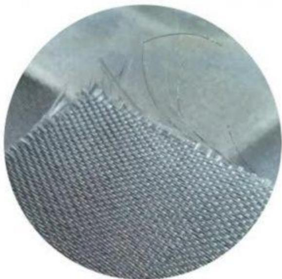
Стеклоткань высокого качества, покрытая полиуретаном с алюминиевым пигментом на одной стороне. Имеет проволочное вплетение. По сравнению с базовой тканью, она имеет очень хорошие свойства, как хорошей устойчивостью на износ, прочностью к растяжению, водостойкость, и огнестойкость. Стальная проволока повышает прочность при высоких температурах.
